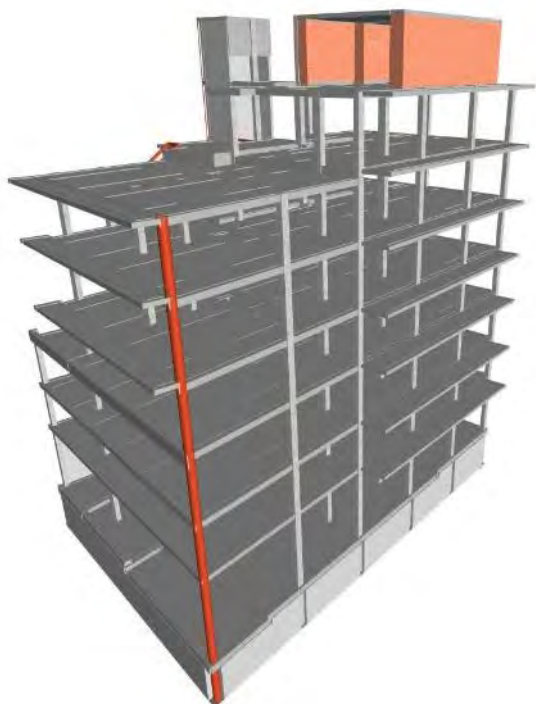
FIGURA 12. Model de CYPECAD per a simular l'estructura de formigó. FONT: Estudi M103, SLP.
