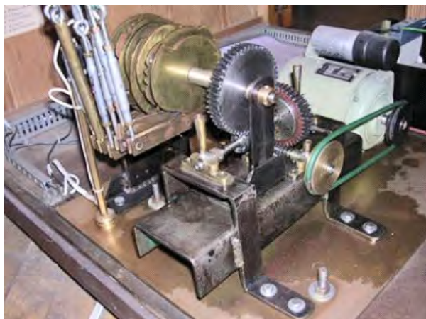
FIGURA 12. Mecanisme intern de Pallasso i granota (1913), de Gustave Vichy, un cop restaurat. FONT: Arxiu tècnic de Lluís Ribas Duran.
