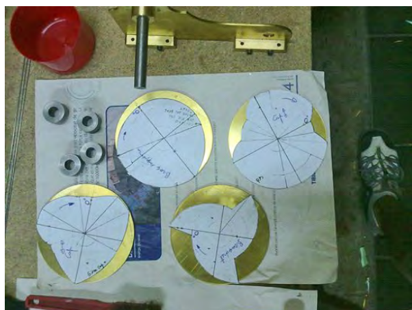
FIGURA 22. Diagrames de llesques, fets en paper, com a plantilla per a retallar les peces de llautó que serviran de llesques. Dibuixos de petits mecanismes i càlculs de recorreguts, de distàncies, de gruixos, etcètera, formen l'univers diari de la construcció i la conservació dels autòmats. FONT: Arxiu tècnic de Lluís Ribas Duran.
